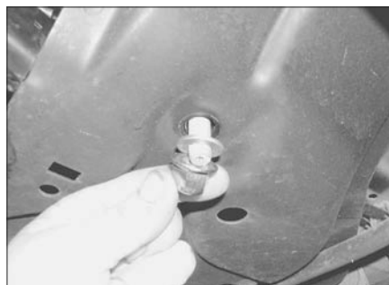
Рис. 19.7,а. Отверните гайки крепления рулевого механизма и снимите шайбы
