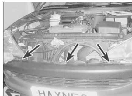
Рис. 6.4. Отверните три болта крепления бампера
