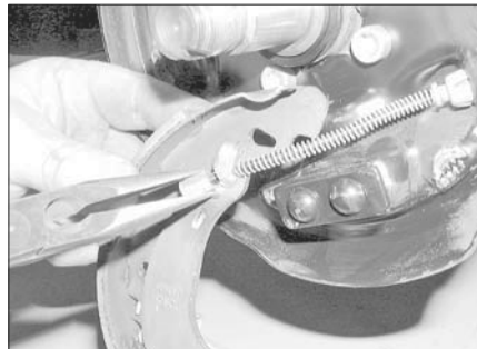
Рис. 6.8,б. ...отсоедините трос стояночного тормоза и снимите с тормозного щита колодку с распоркой
