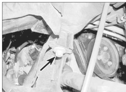
Рис. 19.8,а. Болт переднего крепления подрамника (указан стрелкой)
