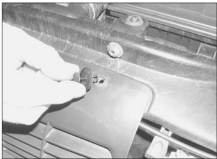
Рис. 6.2,а. Вытянув распорные сердцевины, снимите четыре пистона, которые крепят декоративную решетку к передней панели кузова...
