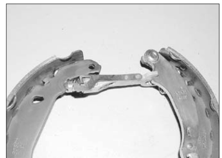
Рис. 6.9,б. ...и деталей распорки, перед тем как разобрать механизм полностью
