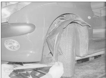
Рис. 6.5,в. ...затем выньте локер из-под арки
