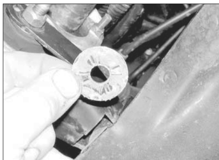
Рис. 19.7,в. ...и выньте шайбы, проложенные между рулевым механизмом и подрамником
