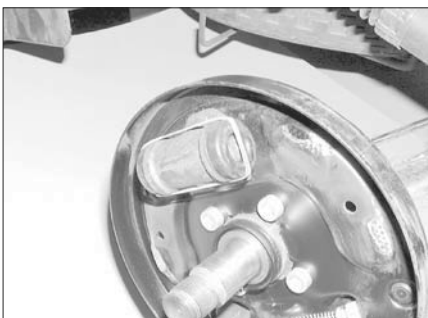
Рис. 6.8,в. Сняв колодки, свяжите поршни рабочего цилиндра пластиковым хомутом или хотя бы аптекарской резинкой, чтобы они не выпали
