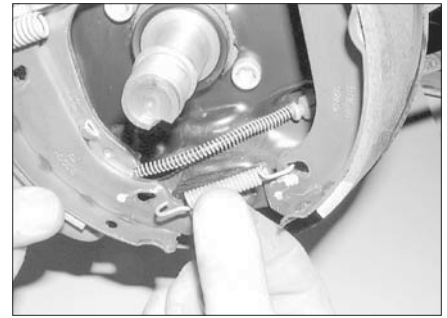
Рис. 6.7,б. ...отцепите и снимите нижнюю стяжную пружину
