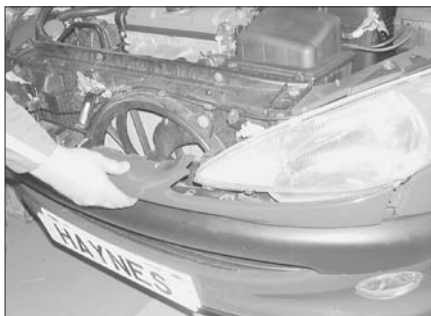
Рис. 6.3,в. ...и снимите панель с автомобиля
