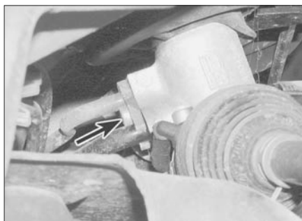
Рис. 19.5. Болт (указан стрелкой) прижимной планки питающей и возвратной трубок — модели с ГУР
