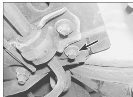
Рис. 19.8,б. Болт заднего крепления подрамника (указан стрелкой)
