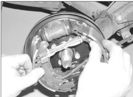
Рис. 6.8,а. Отведите обе колодки от рабочего цилиндра...
