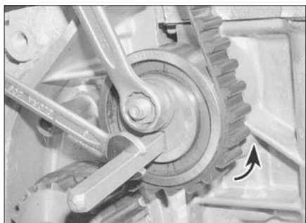
Рис. 6.14. Чтобы выбрать слабины ремня, разверните натяжитель против часовой стрелки и затяните гайку крепления
