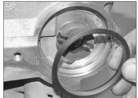
Рис. 9.17. Перед установкой вакуумного насоса тормозной системы установите новую манжету
