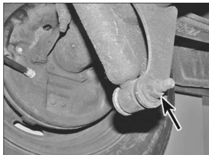
Рис. 13.3. Гайка нижнего болта (отмечена стрелкой)...
