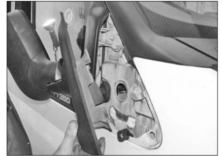
Рис. 21.4. Снимите зеркало в сборе с двери и рассоедините электрический разъем
