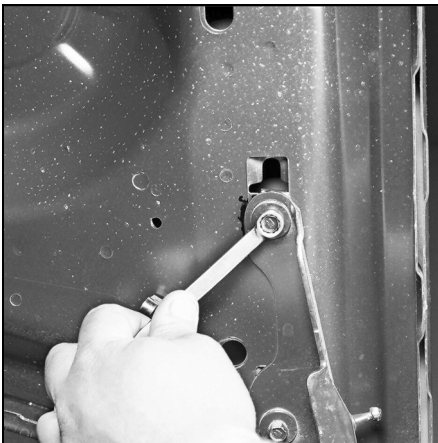
10.4 Отверните болты крепления петель и вдвоём с помощником снимите капот с автомобиля.
