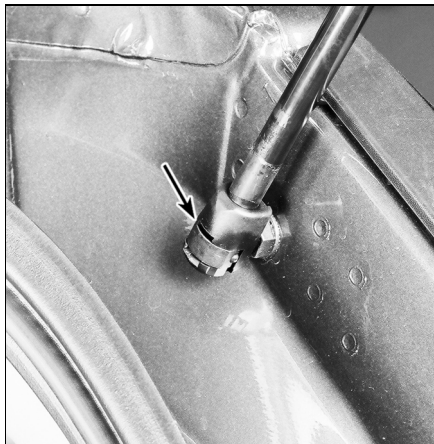
9.2б Перед отсоединением опорных стоек попросите помощника придержать дверь: снимите пружинный фиксатор стойки и отсоедините стойку от шарнира.
