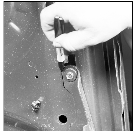
10.2 Перед снятием капота обведите петли маркером.
