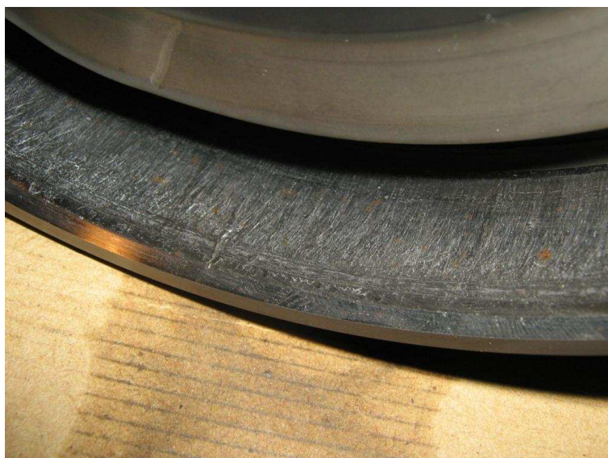
Рис.11 Внутренний поршень – наружный барабан, царапины
