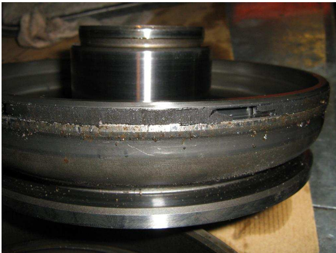
Рис.10 Внешний поршень и износ уплотнительного кольца
