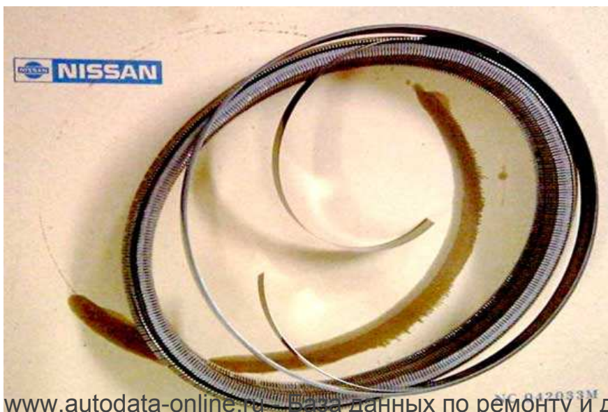
Рис.3 лопнувшая стягивающая лента из пакета.
