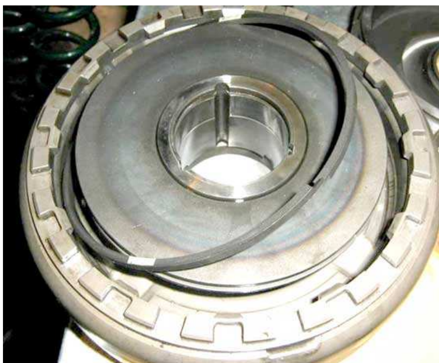
Рис.9 Канавки подвижной половины конуса и второй поршень
