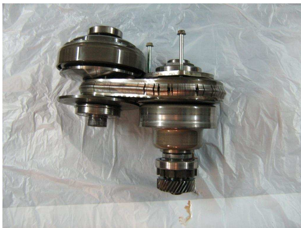
Рис.1 Шкивы и частично осыпавшийся ремень RE0F06A
