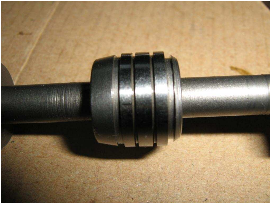
Фото 8 CVT-2 сечение плунжера.
