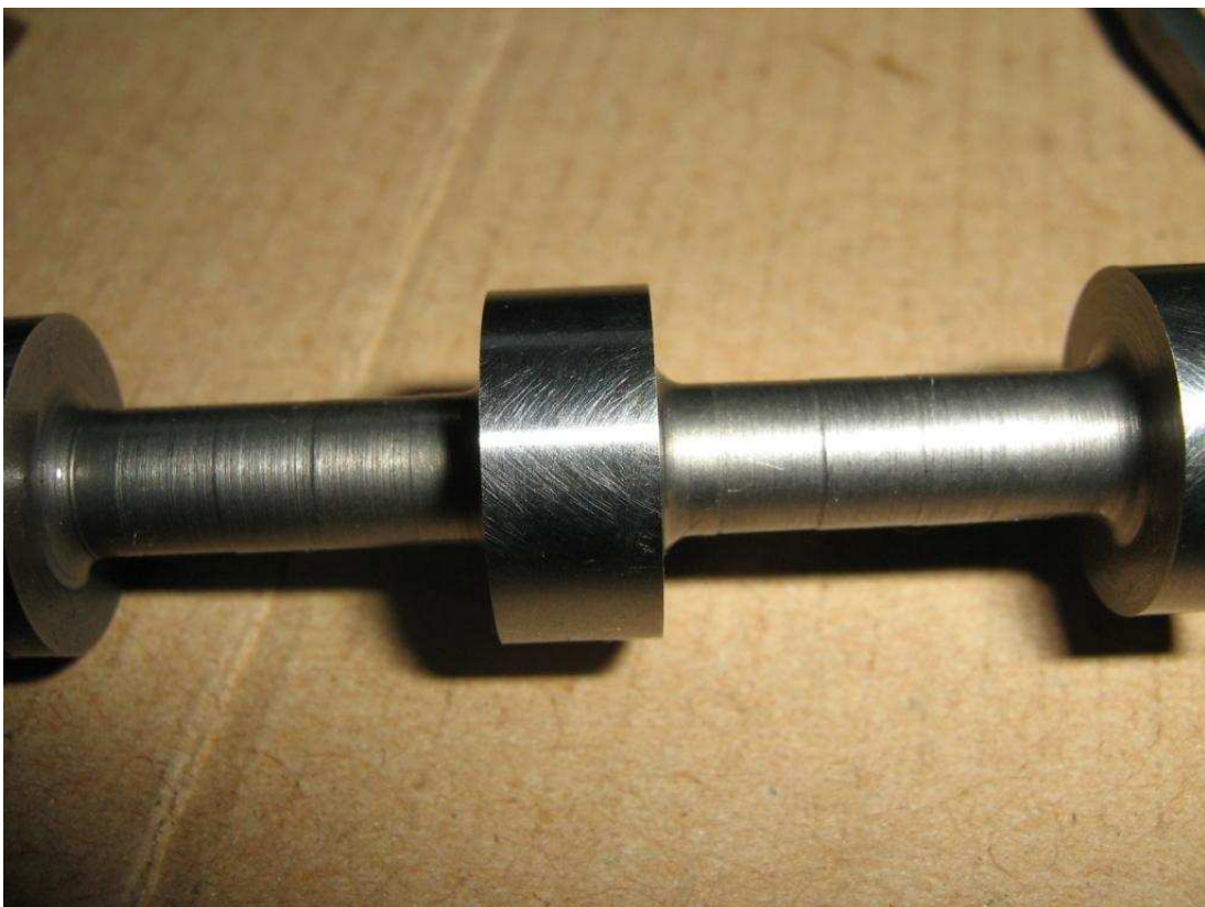
Фото 8 CVT-2 сечение плунжера.
