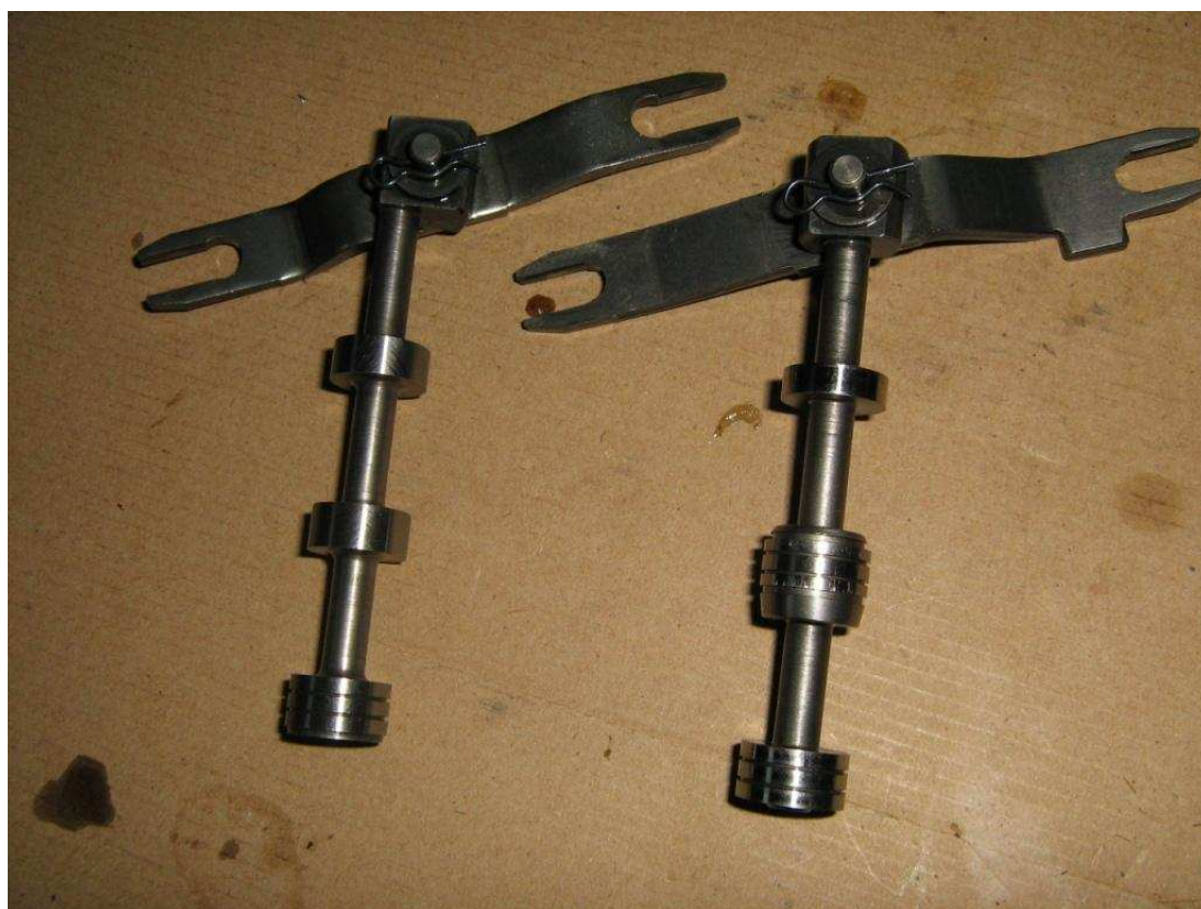
Фото 6 Серволинки изменения передаточных чисел CVT -2 и CVT – 1
