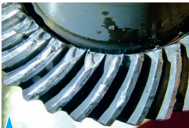
6.261. Разрушение зубьев из-за ударных нагрузок
