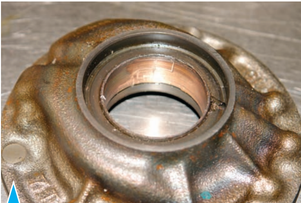
6.60. Изношенный подшипник скольжения насоса
