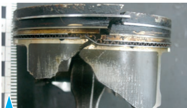
2.36. Разрушение поршня и поршневых колец
