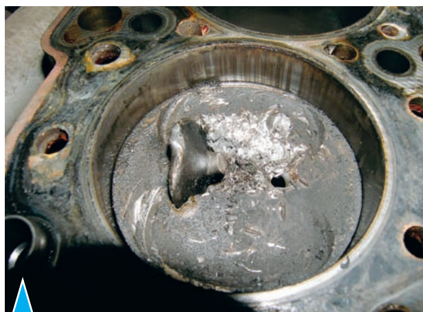
2.31. Разрушение стержня клапана с отделением головки
