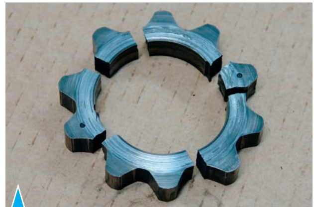
6.63. Разрушение ведущей шестерни насоса
