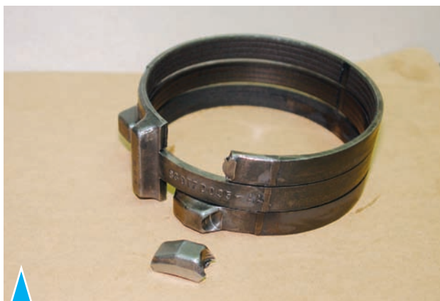
6.441. Разрушение замковой части тройной тормозной ленты
