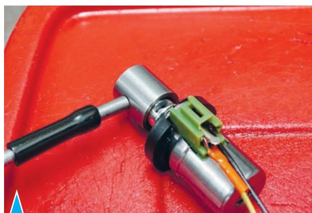
6.188. Проверка работоспособности электрогидравлических клапанов
