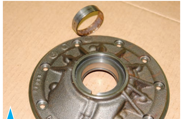
6.61. Разрушенный подшипник скольжения насоса
