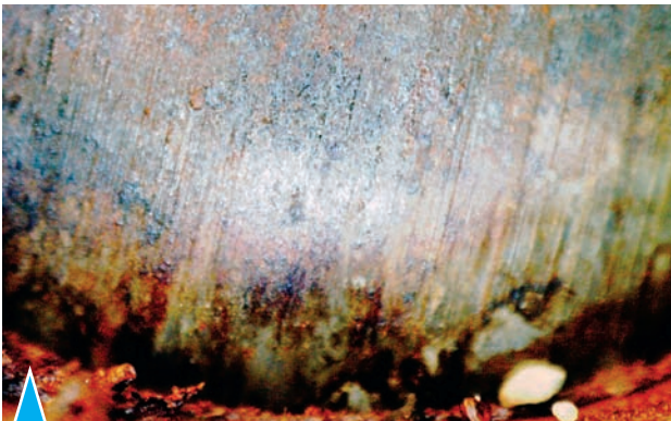
7.13. Коррозионные повреждения и глубокий износ рабочей поверхности шарнира рулевой тяги в результате эксплуатации с разрушенным защитным чехлом
