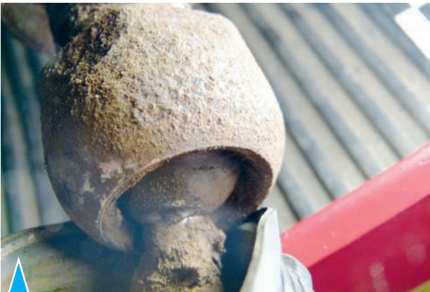
7.12. Коррозионные повреждения шарнира рулевой тяги в результате эксплуатации с разрушенным защитным чехлом
