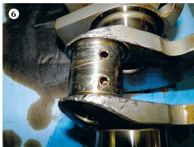
5.346. Стадии повреждения вала при недостаточной смазке: 1 – начальная стадия с переносом материала вкладыша на вал; 2 – то же с задирами; 3 – приваривание вкладышей к валу с заклиниванием и проворачиванием вкладышей в постели; 4 – износ шейки от нештатной работы по стальной основе вкладышей; 5 – перегрев шейки, 6 – повреждение шейки после разрушения вкладышей и кривошипной головки шатуна
