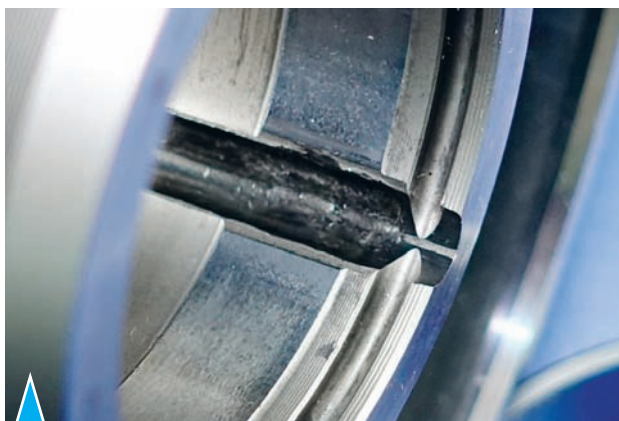
6.319. Износ направляющей подвижной части конуса шкива вариатора
