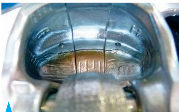
2.34. Разрушение поршня по канавке маслосъемного кольца (вид с внутренней стороны поршня)
