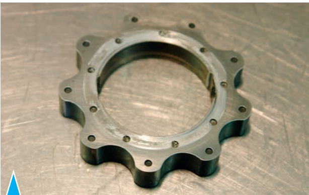
6.62. Разрушение приводных элементов (узов) ведущей шестерни насоса
