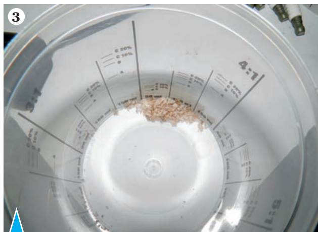
5.117. Последствия попадания в топливо морской воды: 1 – потеря работоспособности форсунок хорошо видна при их проверке на стенде; 2 – коррозия топливного насоса; 3 – соль морской воды на дне заборника топлива; 4 – заливная горловина бака со следами коррозии цинкового покрытия
