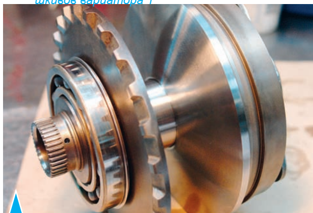
6.318. Состояние конусных поверхностей шкивов вариатора, не имевших чрезмерного буксования
