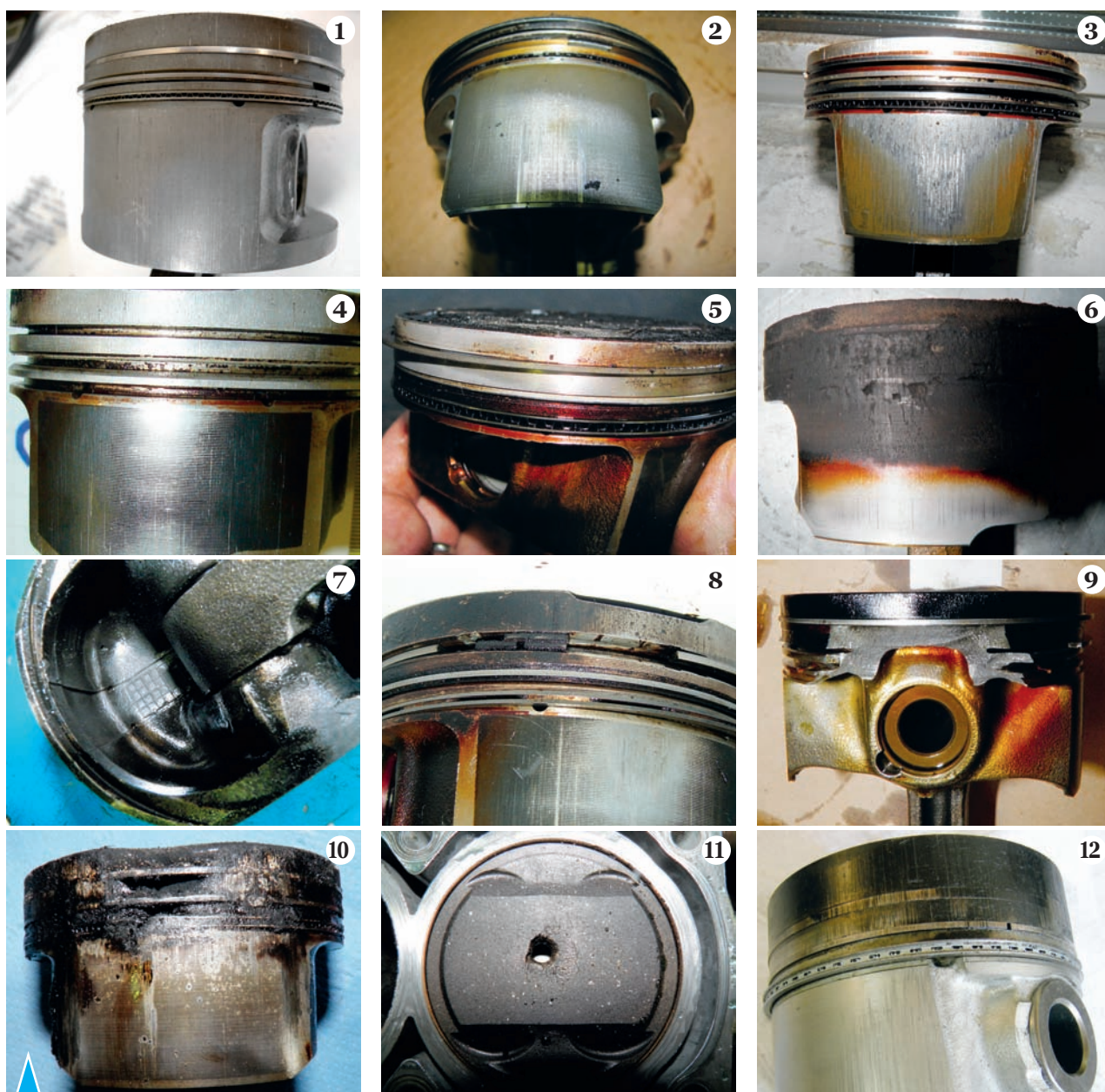
5.194. Основные виды повреждений поршней: 1 – абразивный износ; 2 – повреждение частицами; 3 – задиры; 4 – большой зазор в цилиндре (износ юбки); 5 – неправильная работа из-за деформации шатуна; 6 – низкокачественное масло; 7 – перегрев поршня или некачественное масло; 8 – размывание канавки при колебании сломанного поршневого кольца; 9 – детонация; 10 – перегрев поршня после поломки колец и/или перемычек; 11 – калильное зажигание; 12 – нарушение масляного охлаждения
