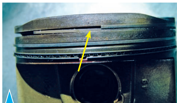
2.37. Разрушение компрессионного кольца
