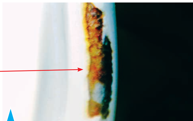
20. Дверь передняя правая – скол лакокрасочного покрытия на задней кромке. Образование продуктов коррозии на поверхности металла (съемка цифровым микроскопом)
